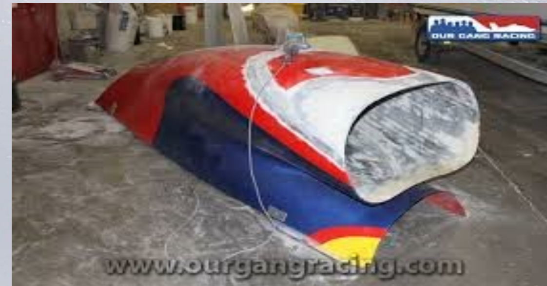
la carlagne (cowling) est une capsule sur le moteur qui sert à protéger le moteur des débris provenant des autres bateaux lors de la course.
