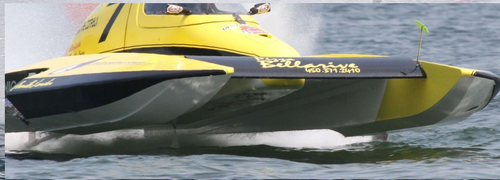
L'effet de sol sous l'hydroplane est aidé par l'aile canard en avant de l'hydroplane pour se décoller de l'eau pour prendre de la vitesse. L'un ne peut pas marcher sans l'autre, l'air qui circule sous le bateau cause le soulèvement du bateau ce qui le fait avancer.
