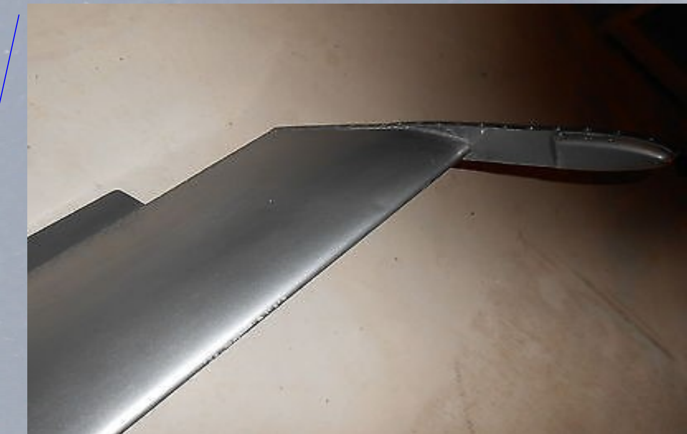
L'aile canard (canard wing) est deux palettes à l'avant de l'hydroplane pour asseoir le devant de l'hydroplane sur l'eau. Stabilise l'hydroplane.
