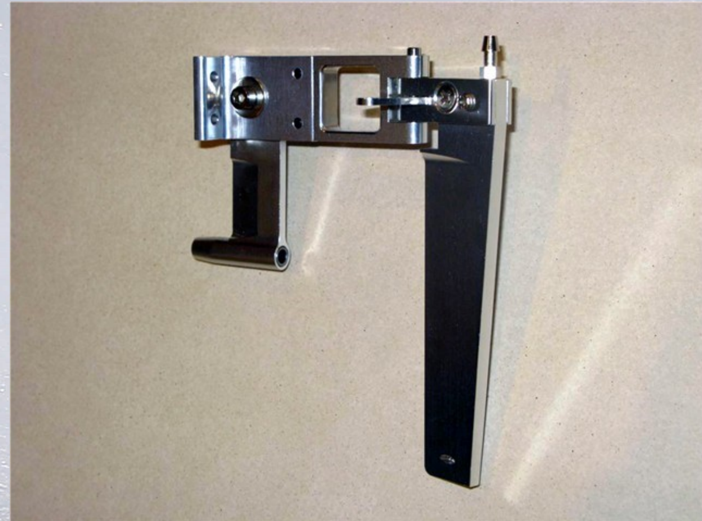
Le gouvernail. (Ram wing) Est une plaque de métal qui sert à diriger l'hydroplane, lors de la course situé à l'arrière de l'hydroplane commandé de la cabine.
