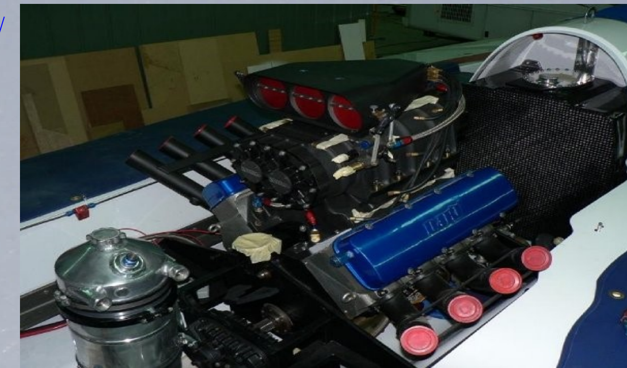
Le moteur (engine) d'un hydroplane est un moteur d'automobile. Modifier de A à Z pour la course nautique
