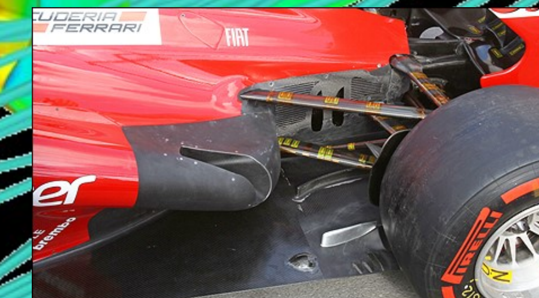
Avant les pneus arrière ont des petits ailerons qui diminuent la turbulence causée par l'aileron arrière.
