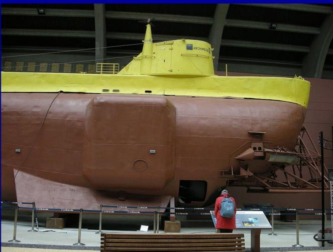
Les **bathyscaphes** sont des engins sous-marins d'exploration abyssale. Un bathyscaphe est constitué d'une lourde cabine sphérique en acier, pouvant accueillir deux ou trois passagers, suspendue à un flotteur rempli d'essence. Le bathyscaphe descend par gravitation et remonte. En raison de leur taille et de leur poids, les bathyscaphes ne pouvaient être embarqués et devaient être remorqués par leur navire d'accompagnement.
